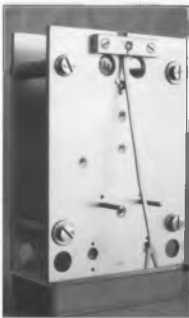
4. Ansicht der Rückseite des Werkes. Deutlich sichtbar die zwei Lagerlöcher für Walze und Gegengespierrhebel, die mit elektrischem Aufzug vorhanden sind.
