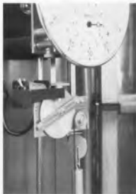
6. Der unterhalb des Werkes angeordnete Ferrarismotor
