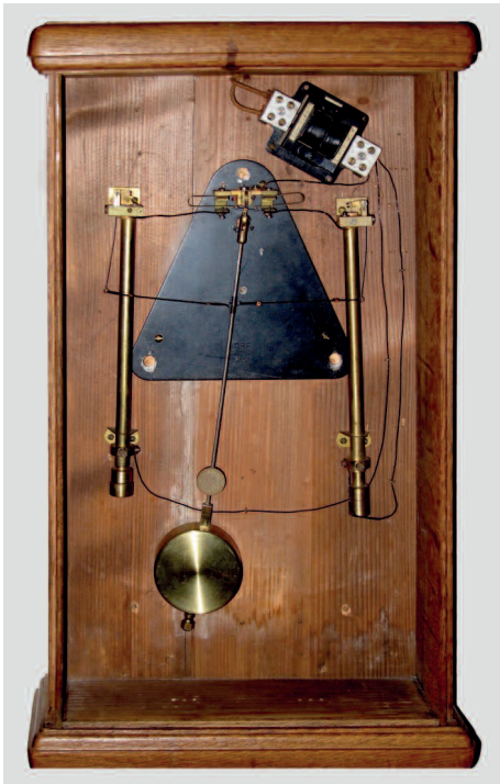
Abb. 14 Bild eines Pendelantriebs für eine Uhr mit Zentralsekunde. Weil die Kraft nicht ausreicht, hat diese Uhr 2 Hitzdrähte, die abwechselnd ein- und ausgeschaltet werden.
