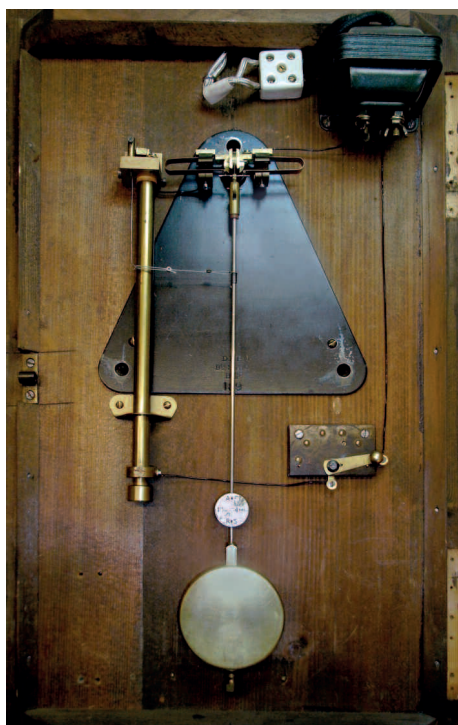
Abb. 5 Die Uhr ohne Gehäuse und ohne Räderwerk. Wenn alles in Ordnung ist, schwingt das Pendel sehr lebhaft, auch ohne das Räderwerk.
