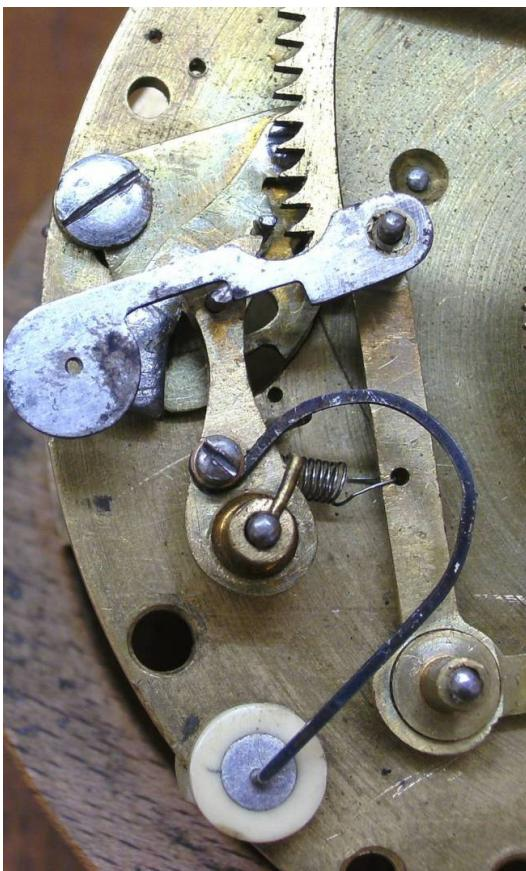
Sieht an sich normal aus, aber im Detail sieht man so eine Art Storchenschnabel, da das Werk keine Warnung besitzen kann. Außerdem sieht man am unteren Ende den Kontakt, der vom Sperrhebel betätigt wird. Rastet der Sperrhebel unterhalb des Rechens ein, so wird der Kontakt unterbrochen und das Schlagwerk steht. Übrigens wird alles durch einen Hebel an der Hammerwelle (!!!) betätigt.
