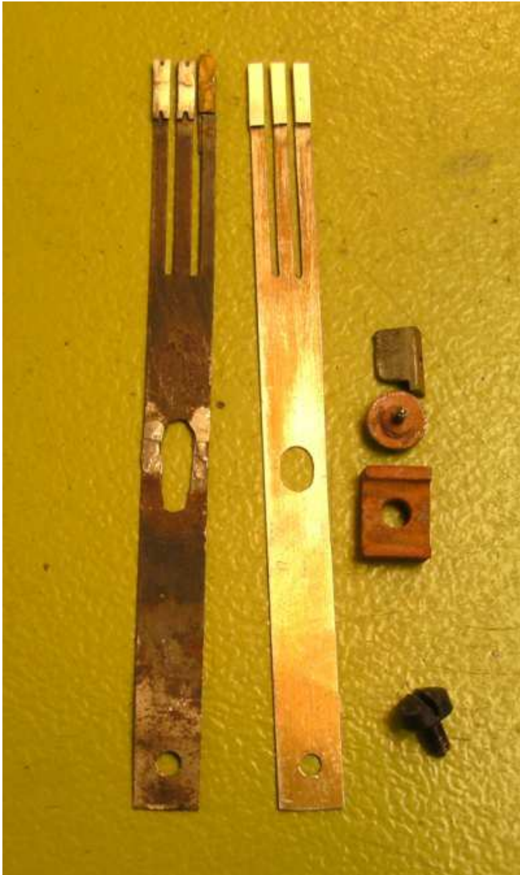
Wie man sieht, war hatte das Altteil vernietete Silberplättchen. Ich habe bewusst darauf verzichtet, denn an dieser Stelle wurde durch je 2 Bohrungen im Stahl das Kontaktärmchen
