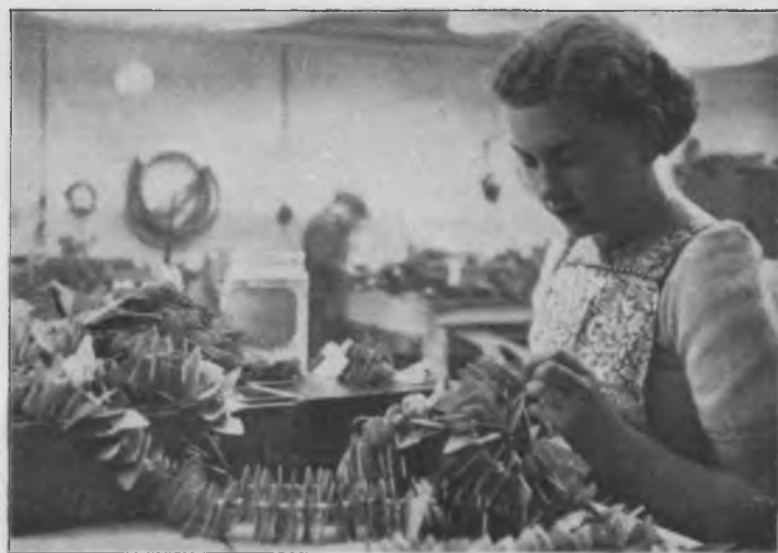
DE ONDERDEELLEN WORDEN MET KRALEN ER TUSSCHEN AAN KOPERDRAAD GEREKEN.
