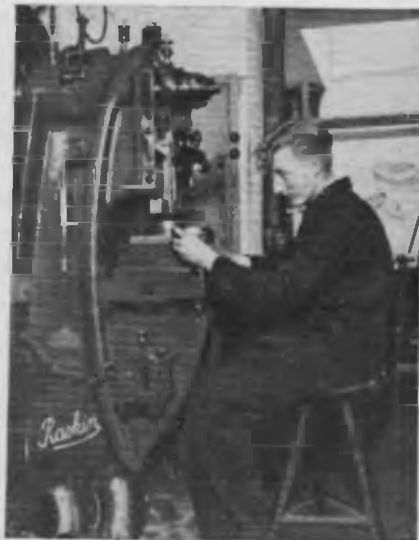
Het uitstampen der onderdeelen op de exenterpers.
