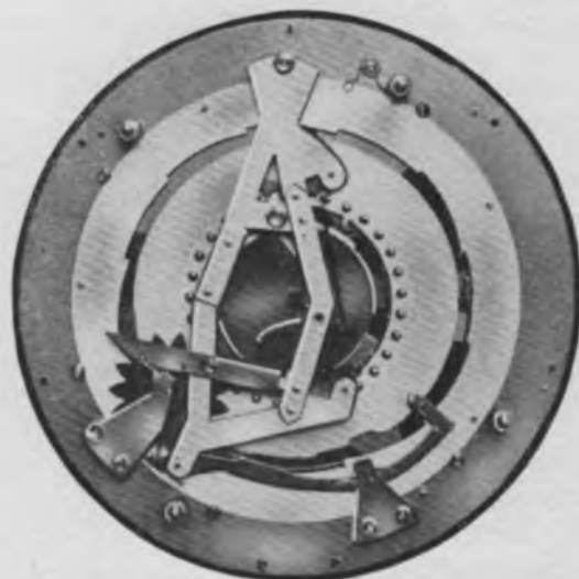
HET KALENDERMECHANISME GEBOUWD VOLGENS HET PATENTSCHRIFT.
