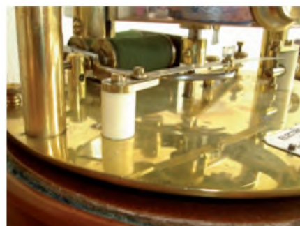
Afb. 3 - Links de twee spoelen van de klok en het Hipp-toggle systeem. Na circa 18 omwentelingen van de balans valt het vaantje in de inkeping van het W-blok en sluit het contact.
