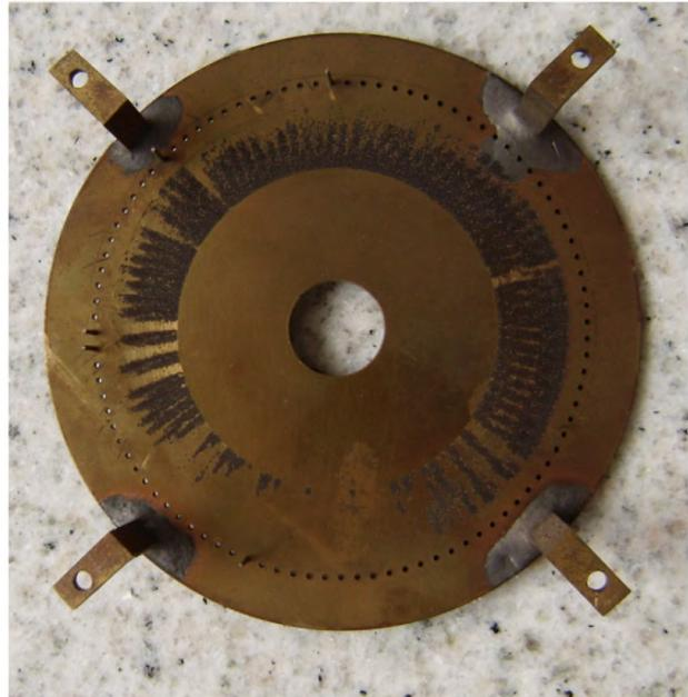
Die Uhr wurde mit Sicherheit für die Schaltung von Starkstrom benutzt. Die Rückseite des 24-Stundenziffernblattes zeigt deutlich die Wirkung der kräftigen Schaltfunken.
