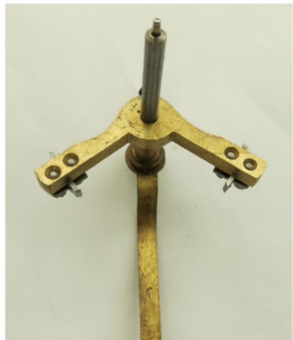
Bis auf das gelochte Steigrad sind alle Zahnräder massive Messingscheiben ohne Schenkel oder Bohrungen. Das Uhrwerk hat eine Graham-Hemmung mit einstellbaren Paletten. Der Anker ist leicht geschwungen und mit einer Schraube auf der Welle fixiert.
