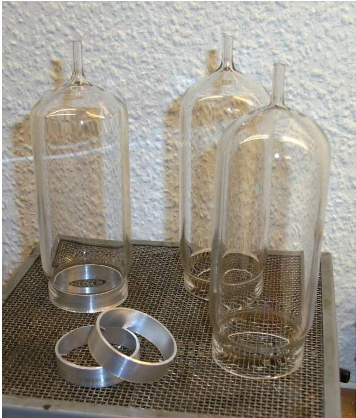
Hier ist ein Ring fertig, er muss dann in den Glaskolben geklebt werden.
