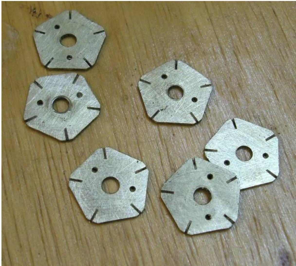
Die Löcher haben eine Funktion: In ein Loch wurde ein M2-Gewinde geschnitten, zur Befestigung des Wärmedrahtes. In Zusammenhang mit dem Bajonettverschluss der Lampe kann der Draht leicht ausgetausch werden, sollte das nötig sein. Durch das andere Loch kann eine Zange fassen, um den Draht gut festschrauben zu können, ohne die doch filigrane Konstruktion zu verdrehen.
