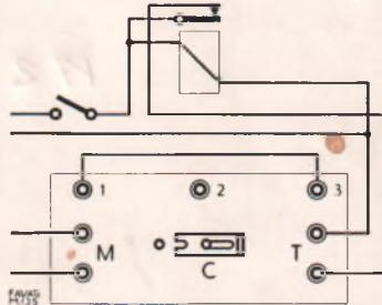
**Messung der Ansprechzeit eines Starkstromrelais mit Starkstromruhekontakt :**
