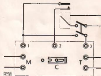
**Messung der Ansprechzeit eines Relais mit Arbeitskontakt :**
