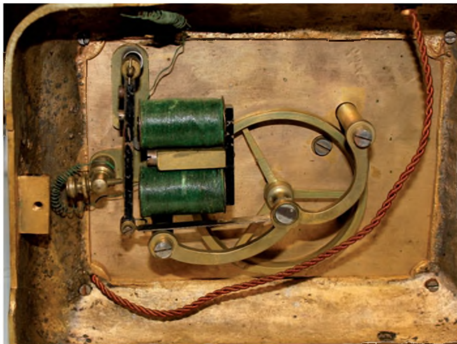
Afb. 4. Deurbelmechanisme in de voet.
