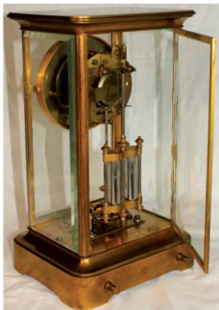
Afb. 1 en 2: elektrische klok van H. Duboulet met compensatieslingers.
