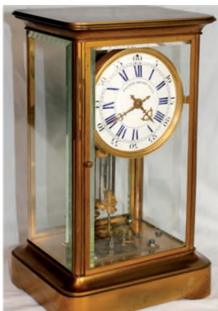
Afb. 1 en 2: elektrische klok van H. Duboulet met compensatieslingers.
