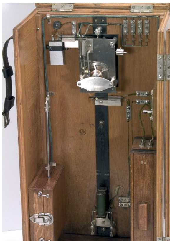
Horloge de référence Favag, avec le balancier rangé dans son écrin, à gauche (photo et collection de l'auteur).
