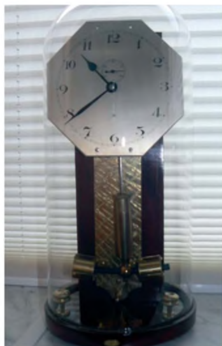
Afb. 5, 6 en 7: Bijzondere ATO onder stolp. Rechter magneetspoel is fake, maar zorgt wel door de inductiespanning voor amplitudestabiliteit. Rechts eenzelfde klok die in licentie door Haller & Benzing werd gedistribueerd.
