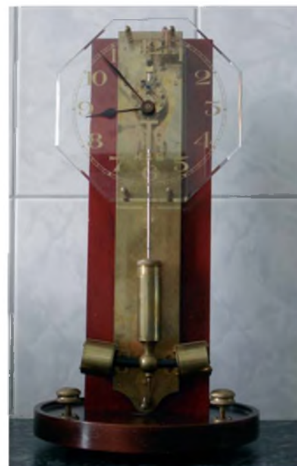
Afb. 5, 6 en 7: Bijzondere ATO onder stolp. Rechter magneetspoel is fake, maar zorgt wel door de inductiespanning voor amplitudestabiliteit. Rechts eenzelfde klok die in licentie door Haller & Benzing werd gedistribueerd.
