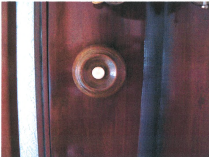
In de kast bevindt zich een knop die bij indrukken na stoomuitval een veer opwindt en zo voor de nodige gangreserve zorgt.
