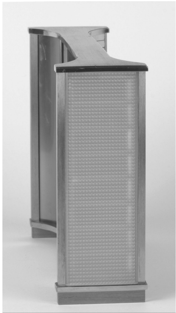
Pendulette de table Ato Lux avec cellule solaire et mouvement électromécanique J 100 de Junghans, Schramberg, vers 1962.
