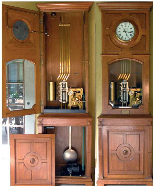
Baugleiche Zeitzentrale Magneta aus der Sammlung Viredaz. Horloge mère Magneta du même type de la collection Viredaz.
