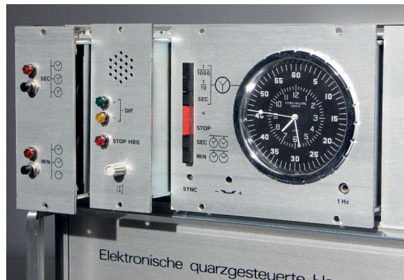
Darstellung des modularen Aufbaus. Exemple de construction modulaire; on peut remplacer les modules sans arrêter l'installation.
