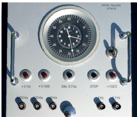
Chronotome CCD zum Einbau in Schaltschränke. Chronotome CCD destinée à être incorporée dans des armoires de connexion.
