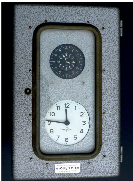
Patek Philippe Marinechronometer der Serie Chronoquartz in der Ausführung für die Firma Auricoste. Chronomètre de marine Patek Philippe de la série Chronoquartz dans l'exécution pour la maison Auricoste.
