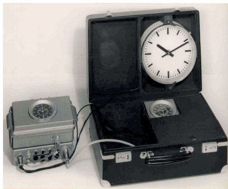
Kompletter Musterkoffer des Chronotome C als Mutteruhr. Coffret échantillon complet de la Chronotome C horloge mère.
