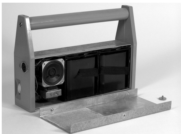
Portescap T75A Le premier instrument à recevoir les signaux n'était pas une horloge mais une radio à transistors qui rendait le signal audible.
