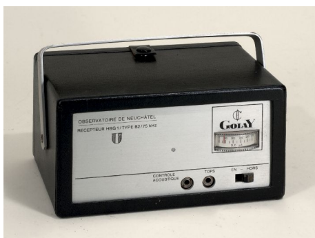
Golay HBG1 Typ B2 Récepteur Golay pour signaux HBG. Ce genre de récep-
