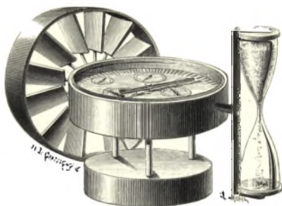
Fig. 111. — Anémomètre enregistreur portable.
