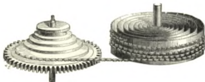
Fig. 49. — Ressort moteur et sa fusée.
