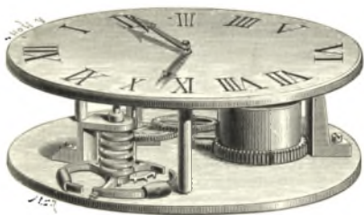
Fig. 60. — Mécanisme intérieur d'un chronomètre.
