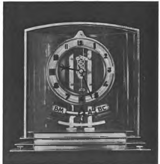
Fig. 15. — Pendulette électronique (brev. n° 1.090.564) BC: bobine engendrant le signal d'entrée d'un transistor; BM: bobine attirant l'aimant A.
