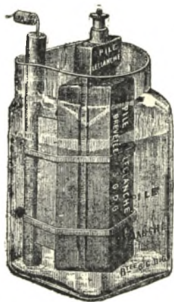
FIG. 12. — Élément à plaques agglomérées.
