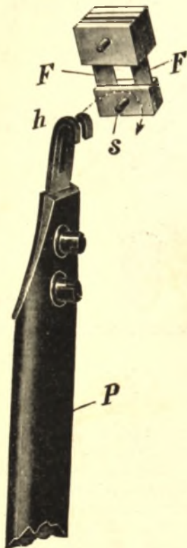
Fig. 18. Het ophangen van den slinger aan de slingerveer.
