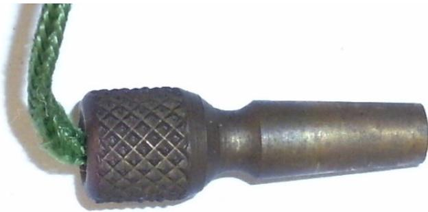
Da es ja bei so einem Uhrenbau auf das Einüben verschiedener Fertigkeiten ankam, wurde natürlich der Stecker von den Schülern gefertigt und hat außen eine Rändelung. Der Konus zum Einsticken musste stimmen. Außerdem wurde das Kabel eingelötet, denn auch das Löten musste ja geübt werden. Dieses Kleinteil ist schon ein Kunstwerk für sich!
