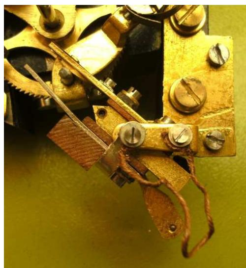
Das ist die normale Position der Wippe, der Anschlag ist elektrisch isoliert. Kein Stromfluss.
