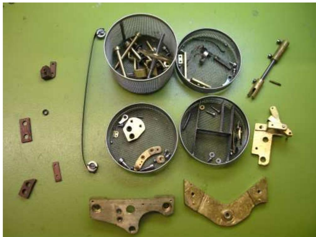
Jede Menge Kleinteile komplettieren den Motor. Einfach ist die Konstruktion nicht und bringt auch am Ende 1,5 kg auf die Waage, wesentlich mehr als das Uhrwerk selbst. Es wurde ordentlich Material eingesetzt. Heute wäre so etwas total unwirtschaftlich.
