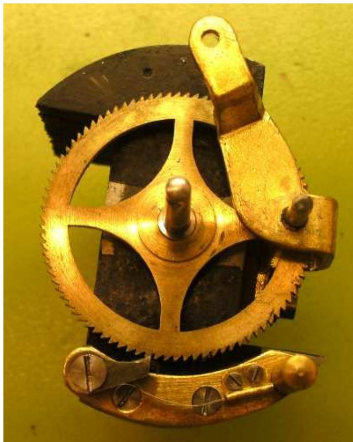
Der Anker hat eine Sperrklinke, damit das Aufzug-Rad transportiert wird. Außerdem einen Silberkontakt, der elektrisch vom Anker isoliert ist. Der Arm trägt das Ende der Zugfeder des Motors. Diese Feder treibt die Uhr an, eine weitere Zugfeder besitzt die Uhr nicht.
