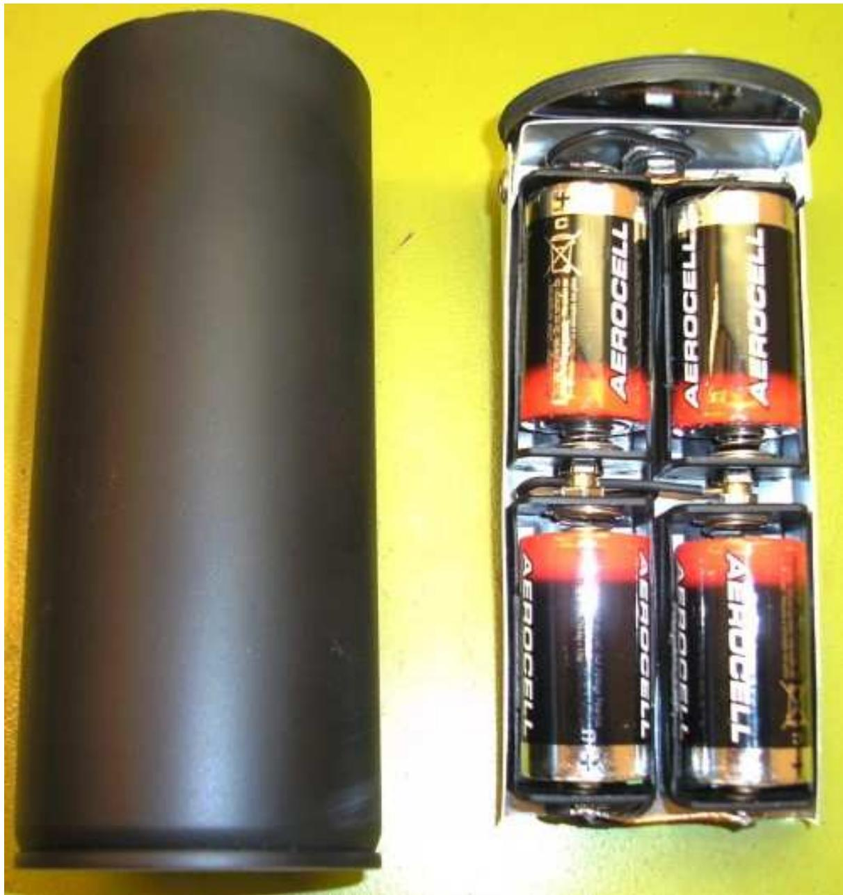
Man sieht, die Zellen passen so gerade eben hinein. Bei einer Monozelle bleibt natürlich wesentlich mehr Platz, und den Batteriehalter kann man direkt am Deckel verschrauben. Dadurch entfällt der Alu-Blechhalter im Innenraum.
