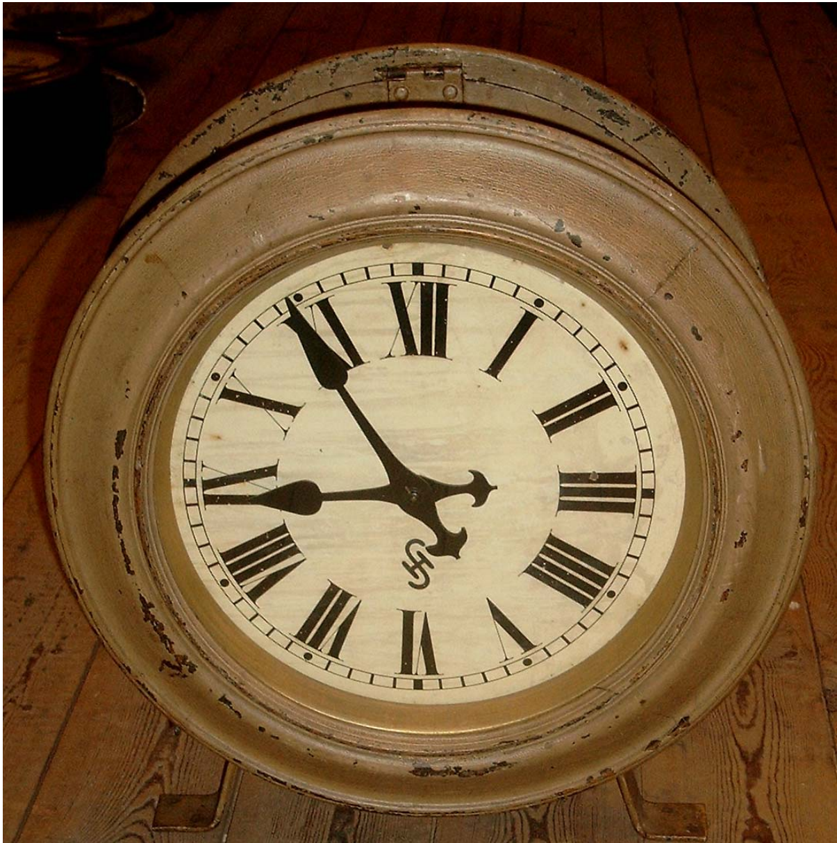
Zweiseitige Nebenuhr für Deckenmontage Schwingankerwerk Privatsammlung, Foto Helsper
