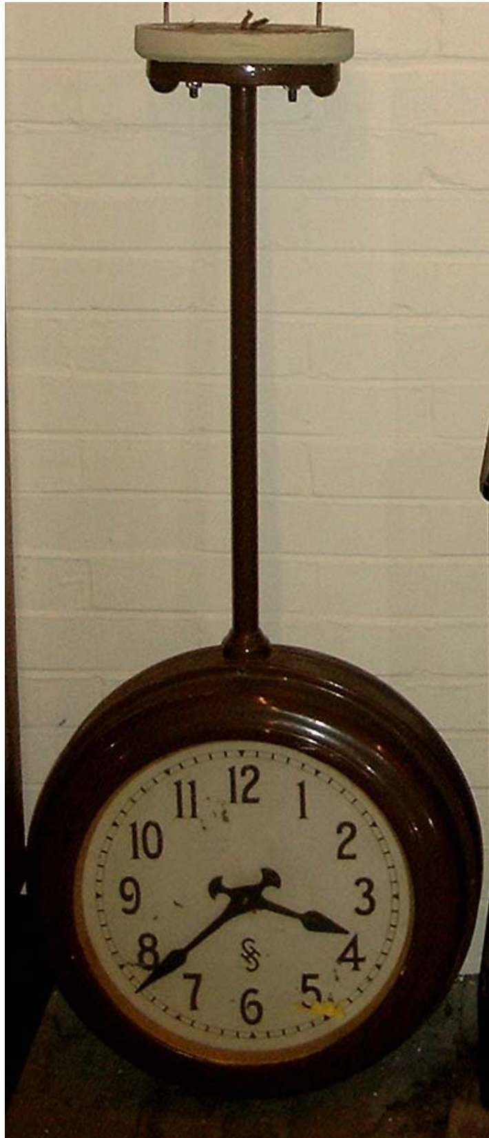
Doppelseitige Nebenuhr am Pendel mit Schwingankerwerk Sammlung Privat, Foto Helsper
