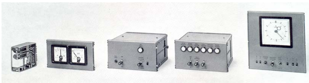
Uhrenzentrale für 6 Uhrenschleifen aus Baugruppen zusammengesetzt
