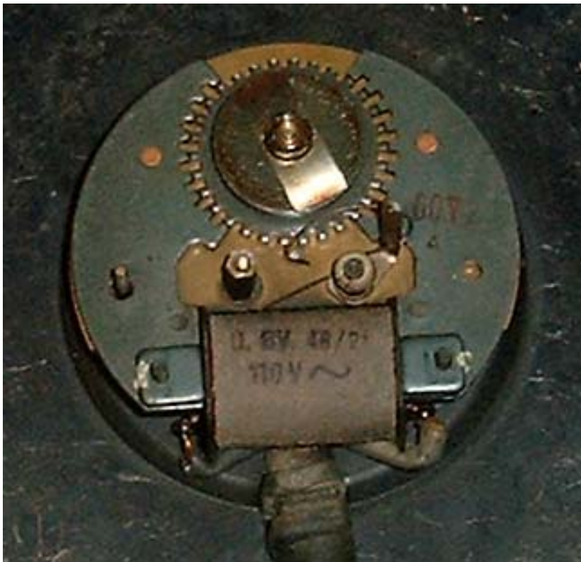
Einheitliche Spule für 110 und 220 Volt durch magnetischen Kurzschlußbügel zur Spule, hier Bügel abgenommen für 110 Volt.
