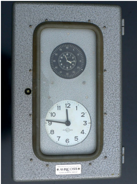
Marinechronometer Chronoquartz in der Ausführung für die Firma Auricoste ab 1964. Chronomètre de marine Chronoquartz dans l'exécution de la maison Auricoste dès 1964.
