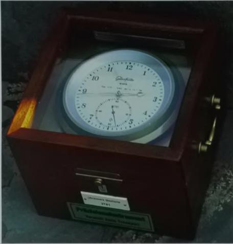
Fig. 28. Glashütte Quartz Marine Chronometer.
