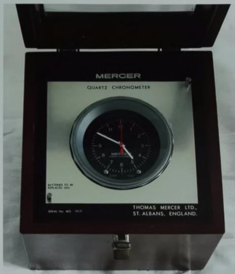
Fig. 16. Mercer/Oscilloquartz B -1390.
